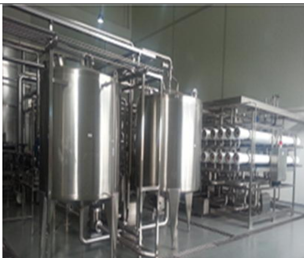
图 1 超滤—纳滤为核心的酱油处理工艺
