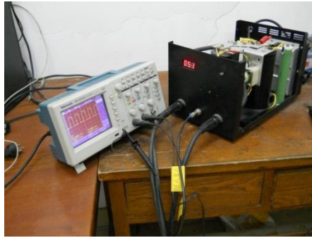
图 3 离电式电容储能点焊机检测
